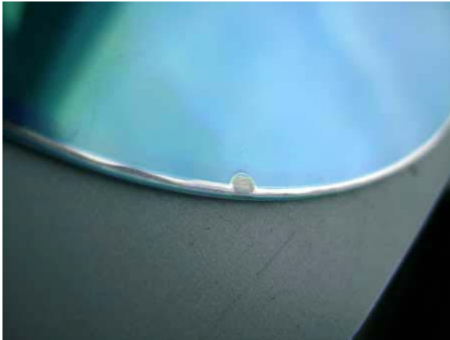
Поврежденные атмосферной влагой участки подложки
